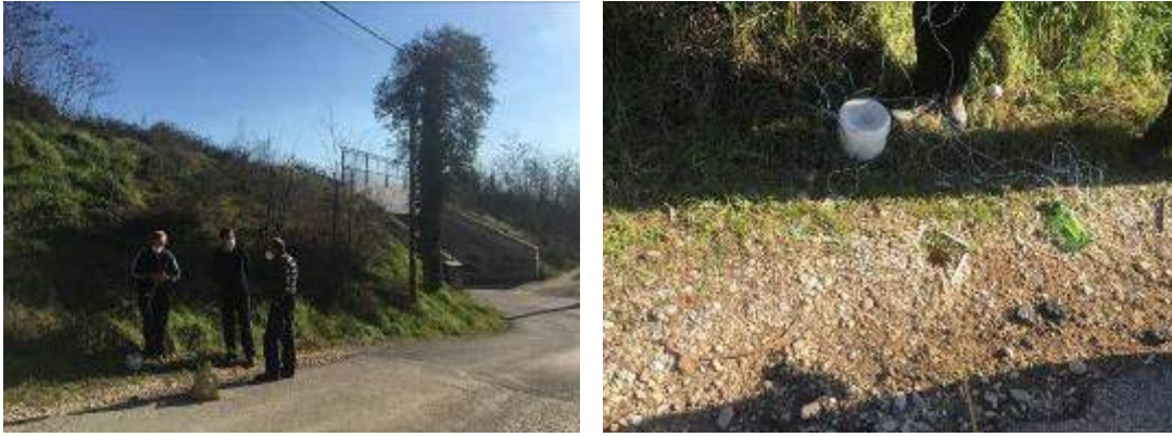
Foto nn. 3-4. Rinvenimento del piezometro e misura della falda superficiale.
